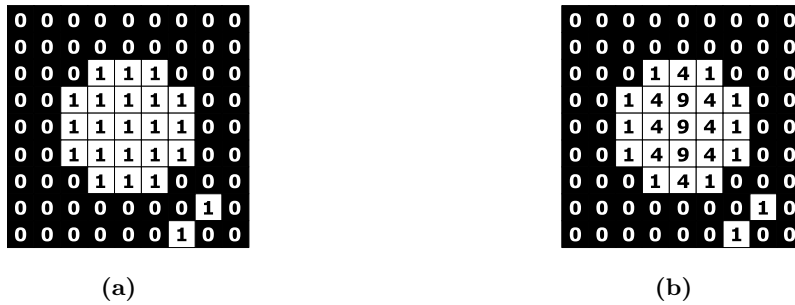
Figura 2.2: Exemplo da transformação 1D comum às TDEs de varredura independente. Tem-se a imagem de entrada F em (a) e sua TDE 1D G ao longo das linhas em (b).
