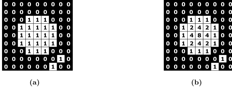
Figura 1.1: Exemplo numérico de transformada da distância. Em (b), tem-se, para cada pixel, sua distância euclidiana ao pixel preto mais próximo. As distâncias são elevadas ao quadrado para que sejam valores inteiros.
